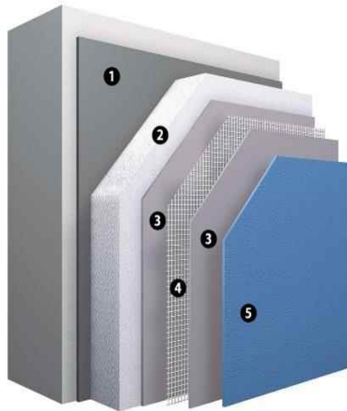
※ 複合断熱システム(湿式外断熱)を
