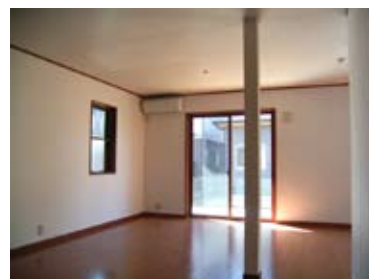
図3：仕上げ材としても使えるボードによりクロスを省略
