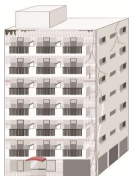
耐震性不足マンション
